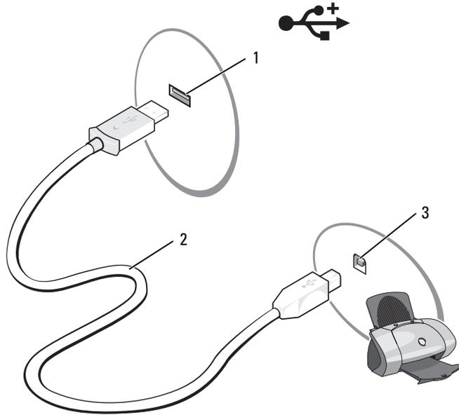
1 connecteur USB de l'ordinateur 2 câble USB de l'imprimante 3 connecteur de l'imprimante
