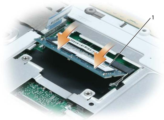
1 languette dans le logement du connecteur
