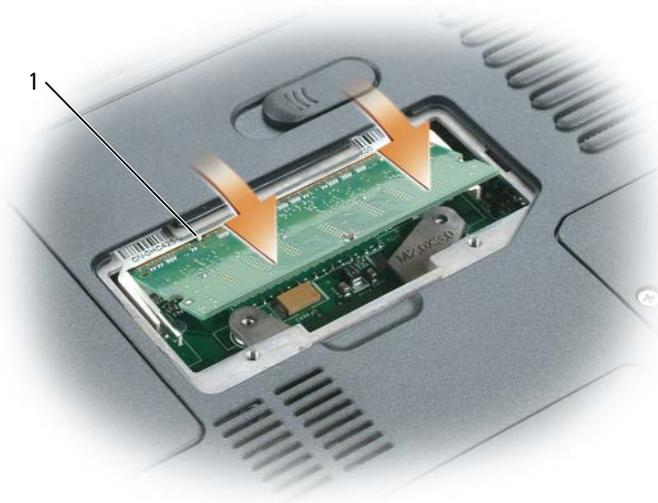
1 languette dans le logement du connecteur
